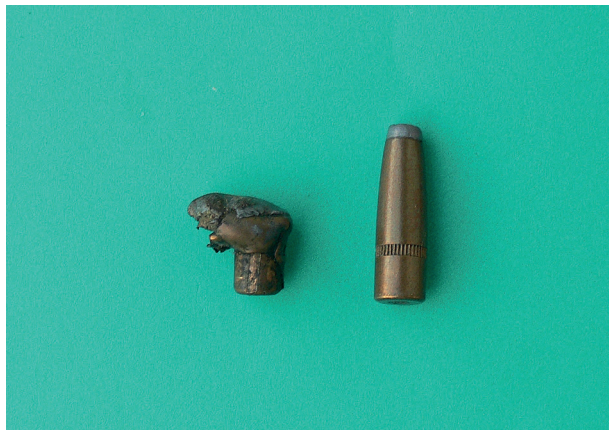
Ryc. 3. Kształt pocisku półpłaszczowego przed trafieniem w korpus zwierzęcia (po prawej) i wypreparowanego z ciała ubitego zwierzęcia (po lewej) Fig. 3. The shape of the half jacket bullet before it hit the body of the animal (on the right) and recovered from the carcass of the shot animal (on the left)
